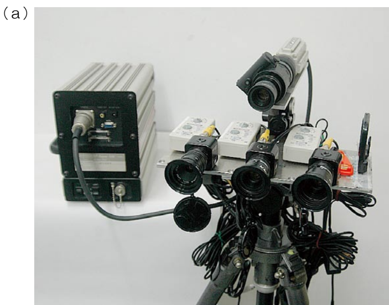
圖2 (a) ISUAL團隊所建立的TLEs多波段觀測系統，與高速攝影系統。(b) 架在飛機窗口的觀測模組。(c) ELF天線。
