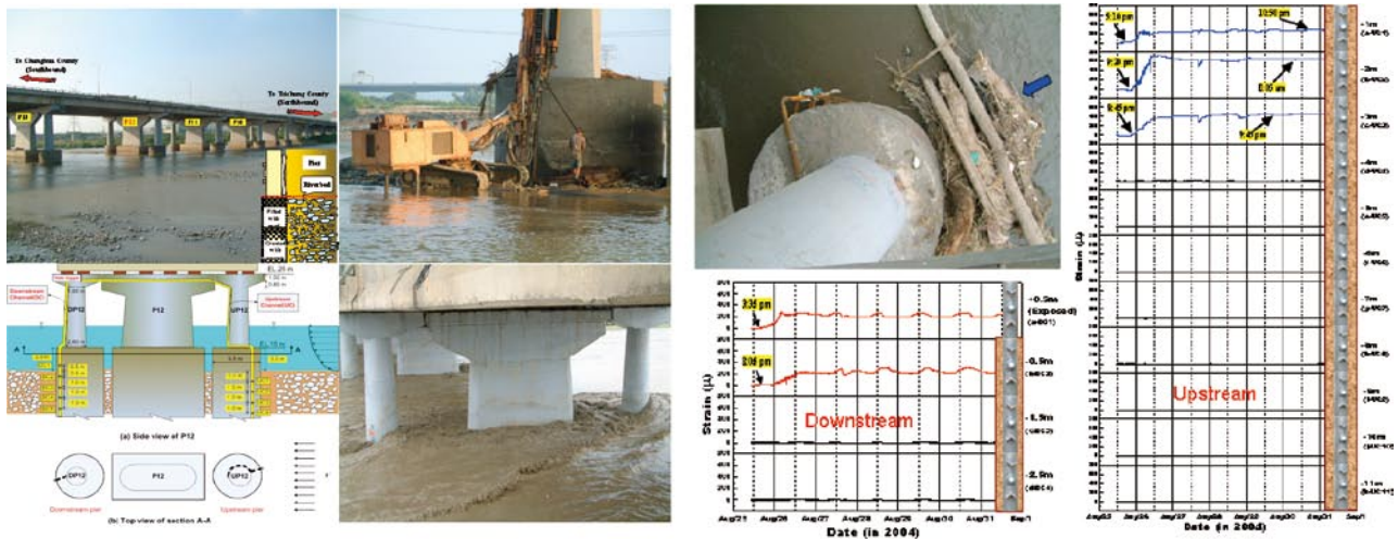
圖1 台一線大度橋光纖橋梁冲刷監測系統。
