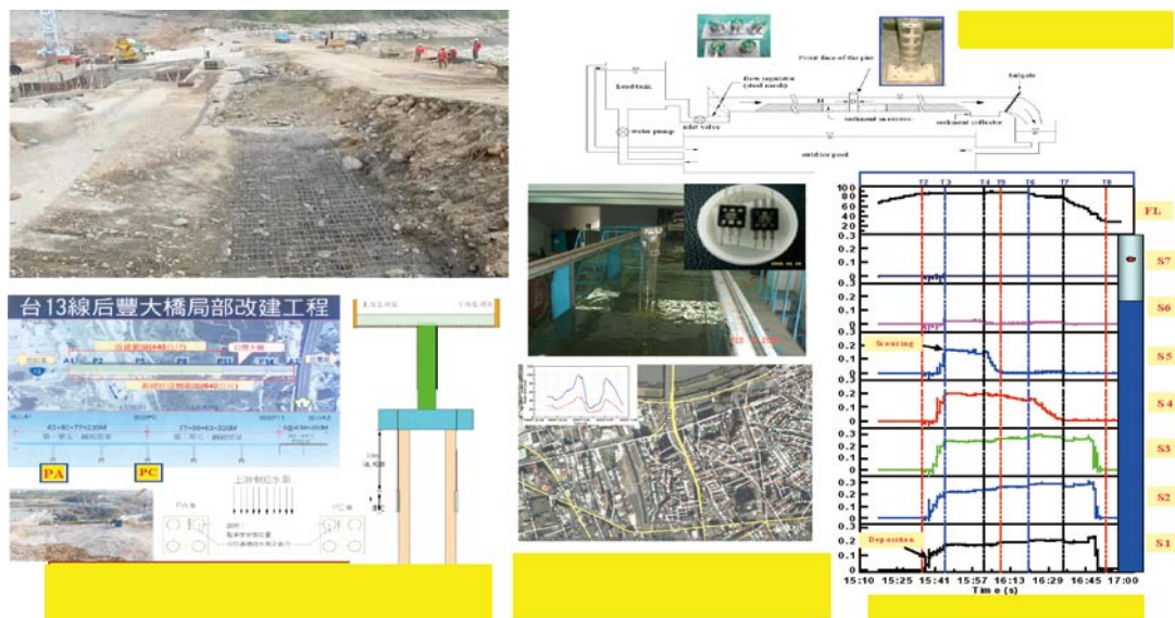
圖2 后豐橋微機電橋梁即時沖刷與地震監測預警系統與台北縣颱風豪雨即時都市積淹水預警系統。
