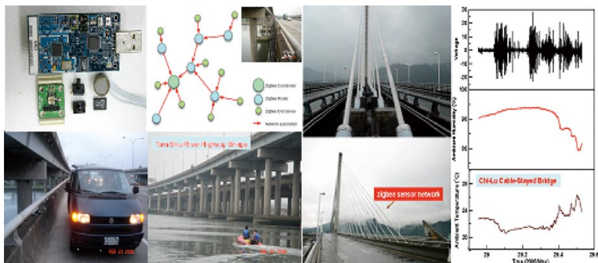
圖3 高速公路淡水河橋及南投縣集集斜張橋梁颱風、地震長期行為zigbee監測網路。
