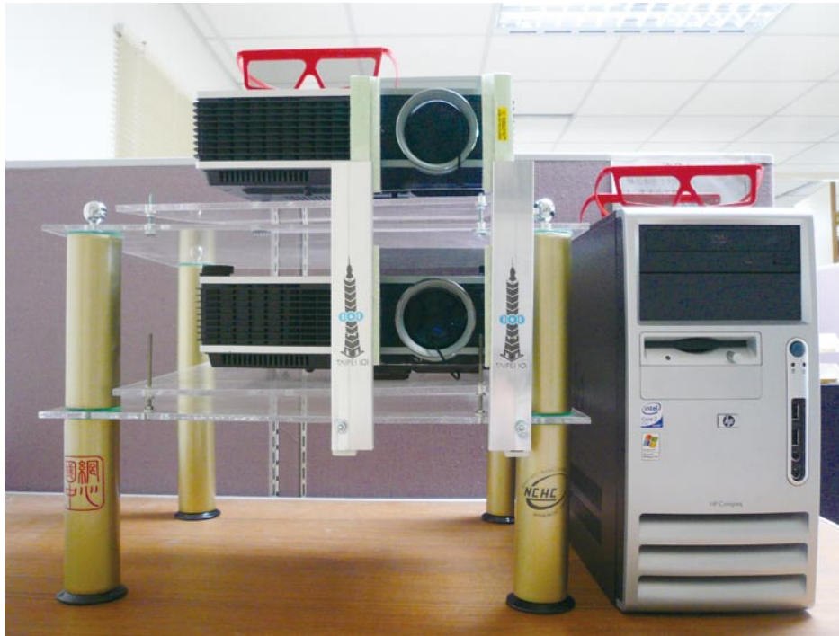
圖2 可攜式3D立體影像快速校準投影輔助裝置。
