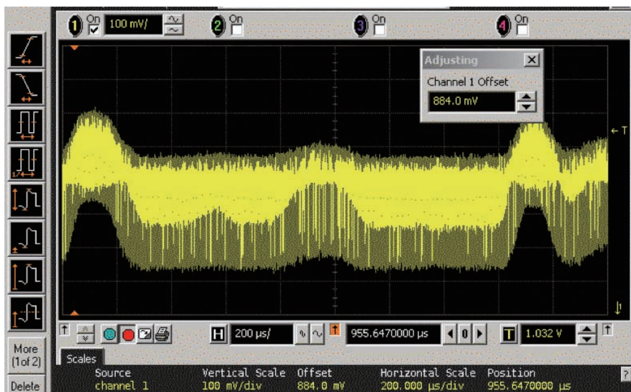
圖 8 於不同的加速度下晶片訊號輸出波形。
