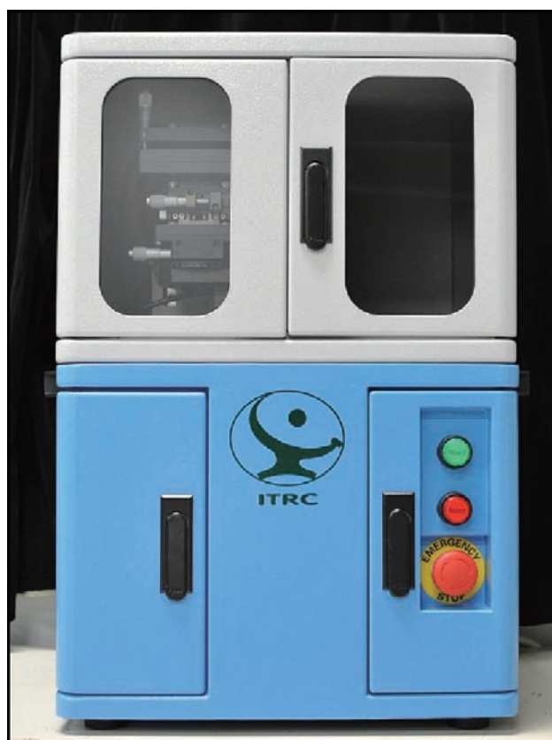
圖6 MTF 量測儀機台實體圖。
