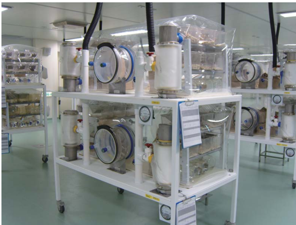
圖1 隔離操作箱設備。
