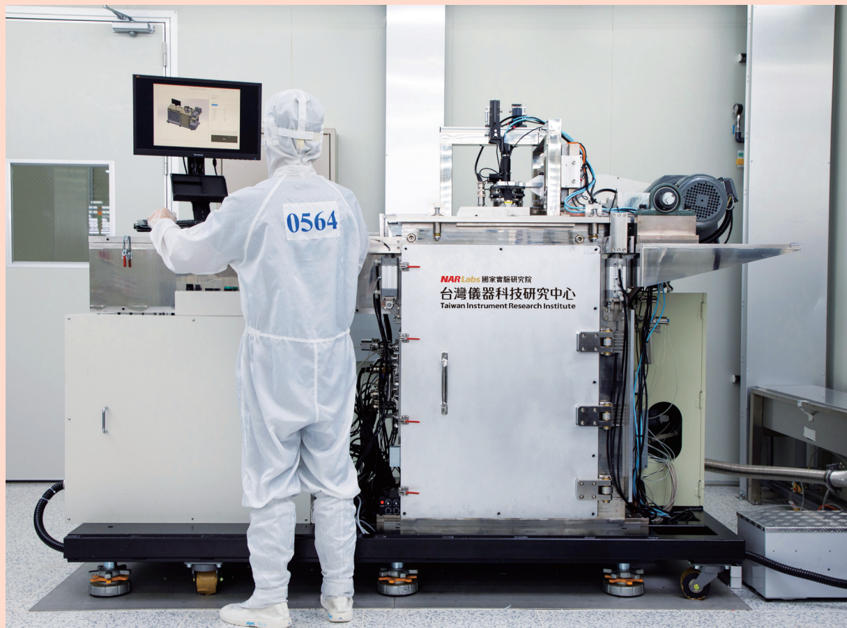
儀科中心世界首創「晶圓級氣體感測器高效能點測系統」
