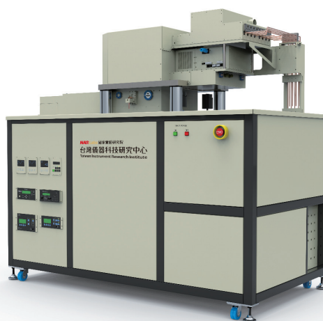
儀科中心自研自製國內第一台原子層蝕刻系統原型機
