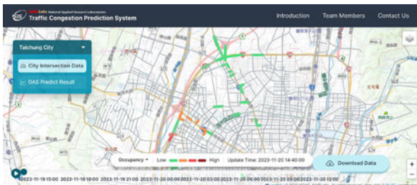
▲ 交通壅塞預測系統運用大數據預測 30 分鐘後道路壅塞情形
