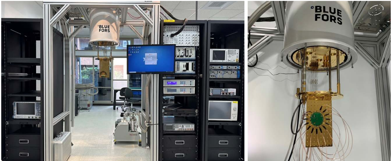
▲ 可達零下 269°C 之電路板級測試平台
