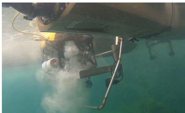
▲ 遠端控制水面無人船佈放觀察型 ROV
