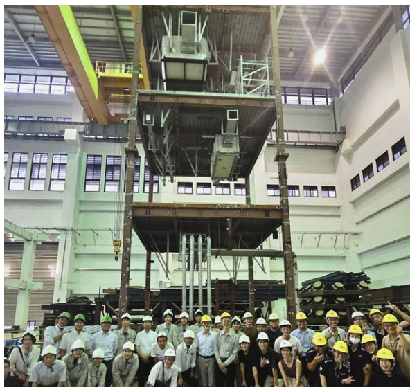
▲ 懸吊式非結構 3 層樓振動台實驗
