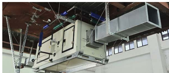
▲ 懸吊式空調箱實驗試體
