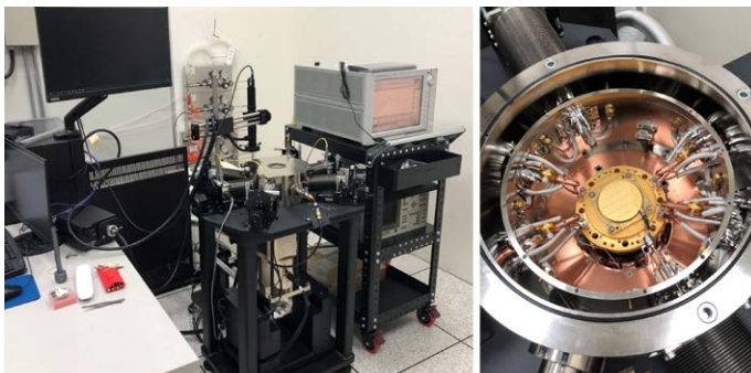
▲ 可達零下 269°C 之晶片級測試平台
