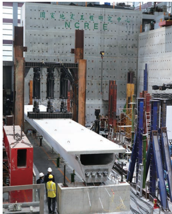
超高性能混凝土預力梁 (U258) 簡支單向加載試驗
