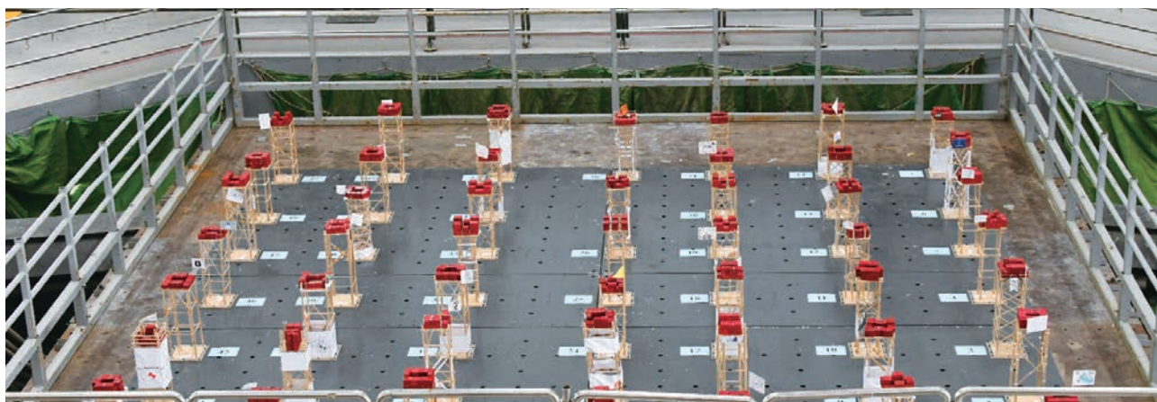
模型安裝於振動台上準備接受考驗
