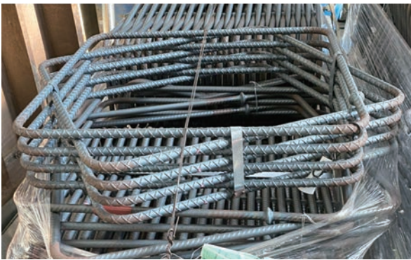
新型電阻銲接閉合型箍筋
